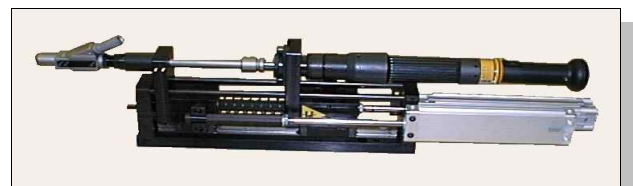
Slitta 4900 bistadio corsa totale 160mm con cilindro di lavaggio compatto ed avvitatore elettronico
