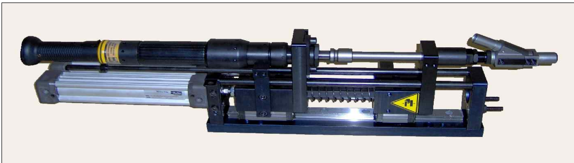
Slitta 4900 Bistadio corsa totale 160mm con cilindro di lavaggio ed avvitatore elettronico
