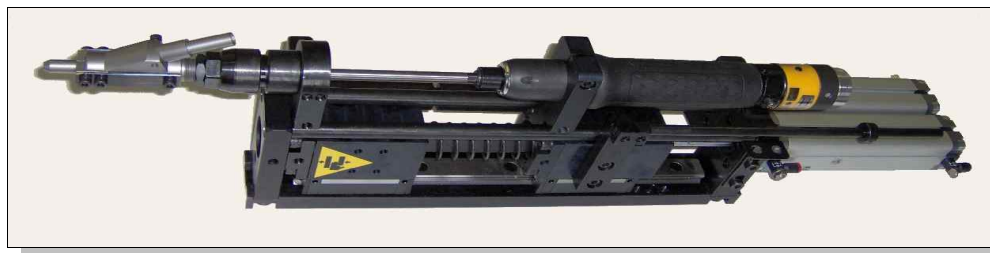
Slitta 4700 Bistadio corsa totale 125mm con cilindro di lavaggio ed avvitatore elettronico
