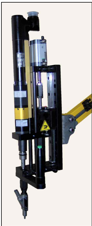
Slitta 3900 IAV con avvitatore elettronico coppia/angolo e comando elettrico
