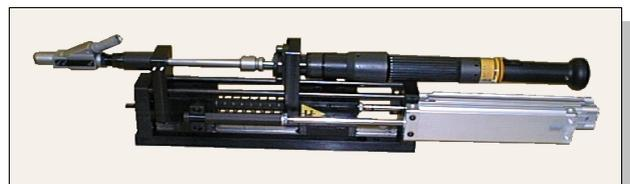
**Slitta 4900 bistadio corsa totale 160mm con cilindro di lavaggio compatto ed avvitatore elettronico**
