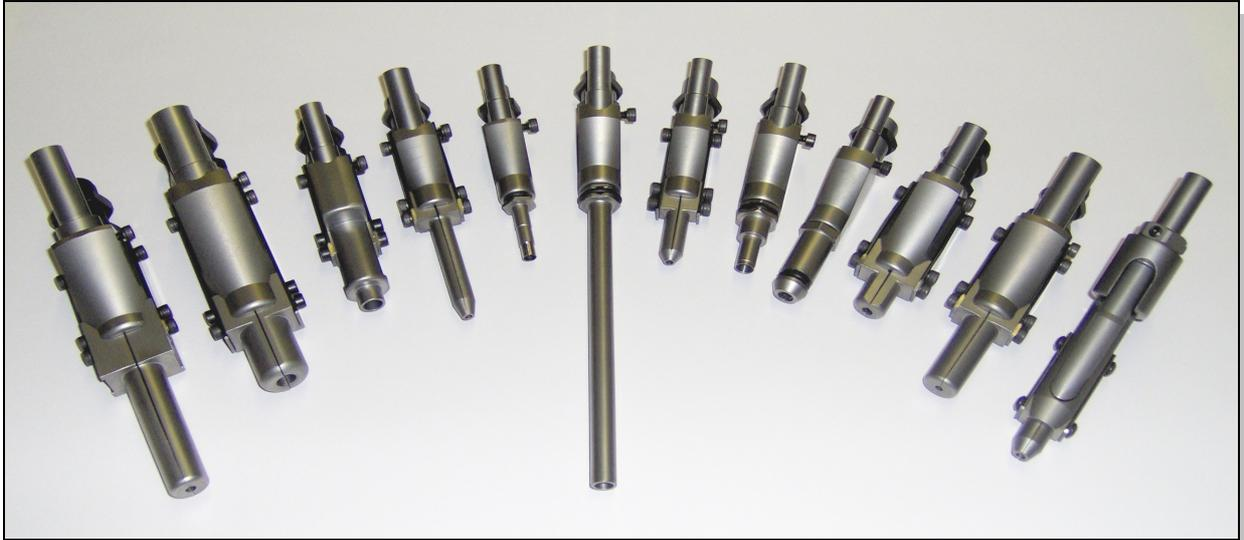
***Le testine di presa vite sono la parte del sistema di avvitatura che presenta il più alto livello di personalizzazione, dato che devono essere adatte all'avvitatura dello specifico componente da assemblare.***
